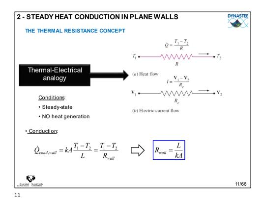
2 - STEADY HEAT CONDUCTION IN PLANE WALLS
