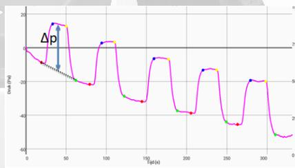
figuur 4: Typisch verloop van het gemeten drukverschil.
