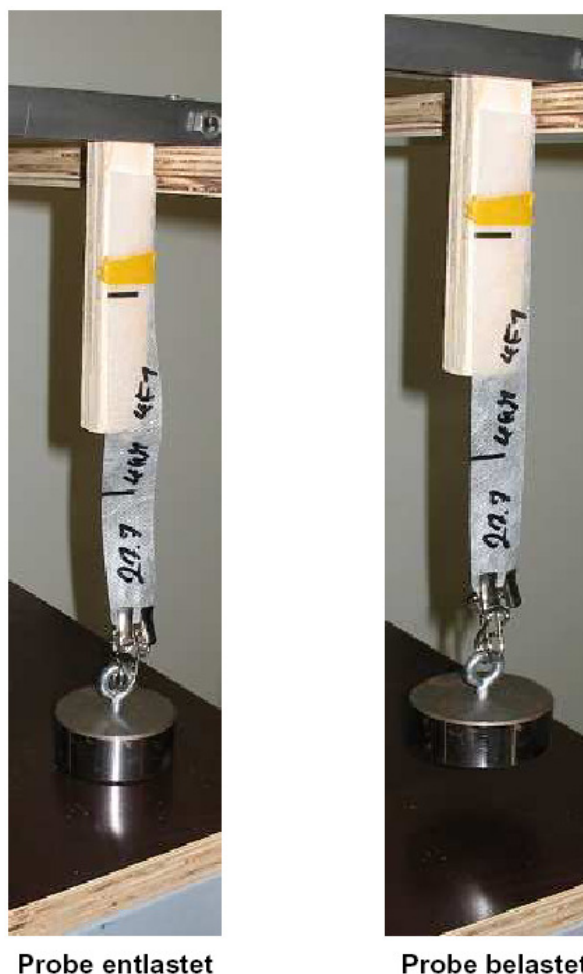
Bild 3: Probekörper während der Wechselbelastung
