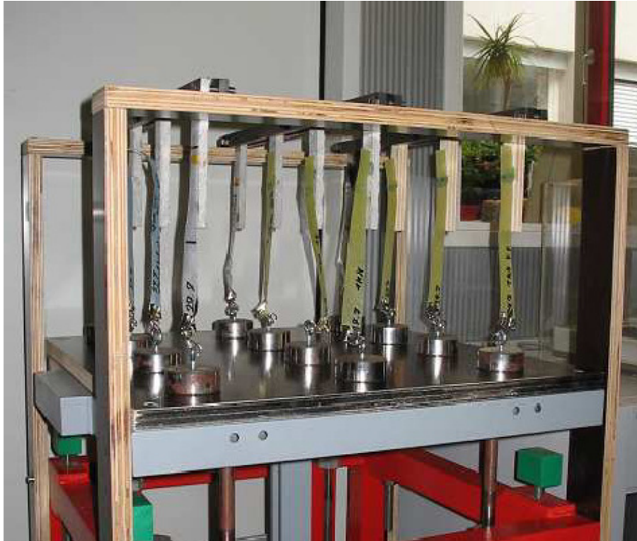
Bild 2: Prüfeinrichtung der Wechselbelastung
